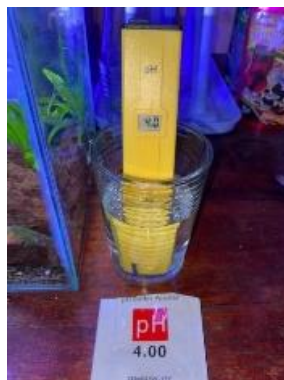
Gambar 8 Hasil kalibrasi pH meter pada nilai pH 4.00
