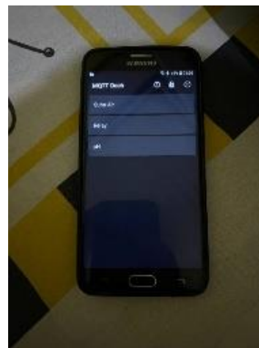
Gambar 13 Monitoring suhu dan pH melalui aplikasi MQTT Dash
