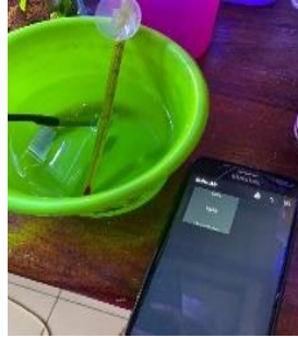
Gambar 3 Pengujian keakuratan termometer dengan sensor suhu
