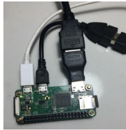
Gambar 18 Pengujian Mikrokontroler Raspberry Pi Zero W
