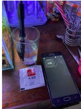
Gambar 9 kalibrasi keakuratan pH meter dengan sensor pH
