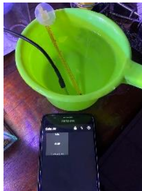
Gambar 5 Pengujian keakuratan termometer dengan sensor suhu
