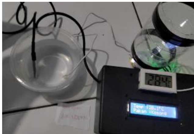
Gambar 8. Pengujian DS18B20 dan Termometer pada Air Normal
