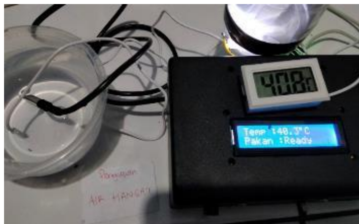
Gambar 9. Pengujian DS18B20 dan Termometer pada Air Hangat
