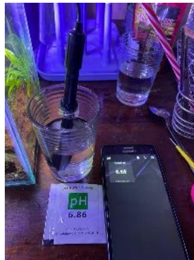
Gambar 7 kalibrasi keakuratan pH meter dengan sensor pH
