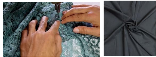
Gambar 14: Proses Pembuatan Sarung Cushion (Penjahitan/Obras) (Sumber: Youtube.com)
