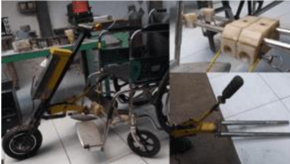
Gambar 4. Prototipe-2, modifikasi mekanisme sambungan [Sumber: peneliti, 2021]
