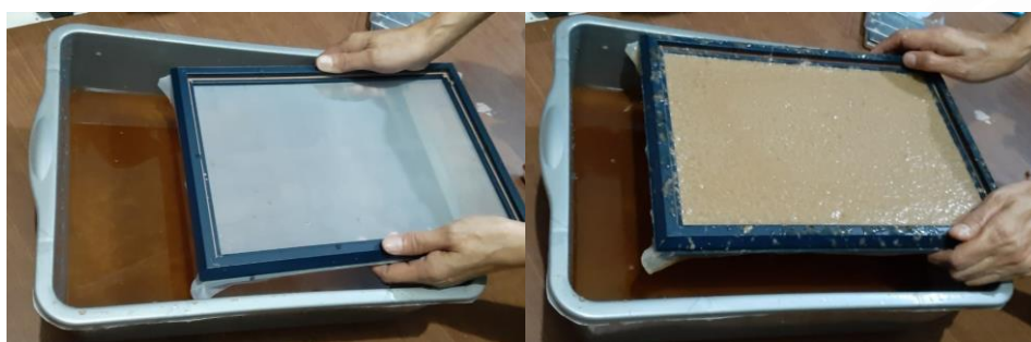
Gambar 7. Kertas daur ulang dicetak pada bidang pencetak [Sumber: dokumentasi mandiri peneliti]
