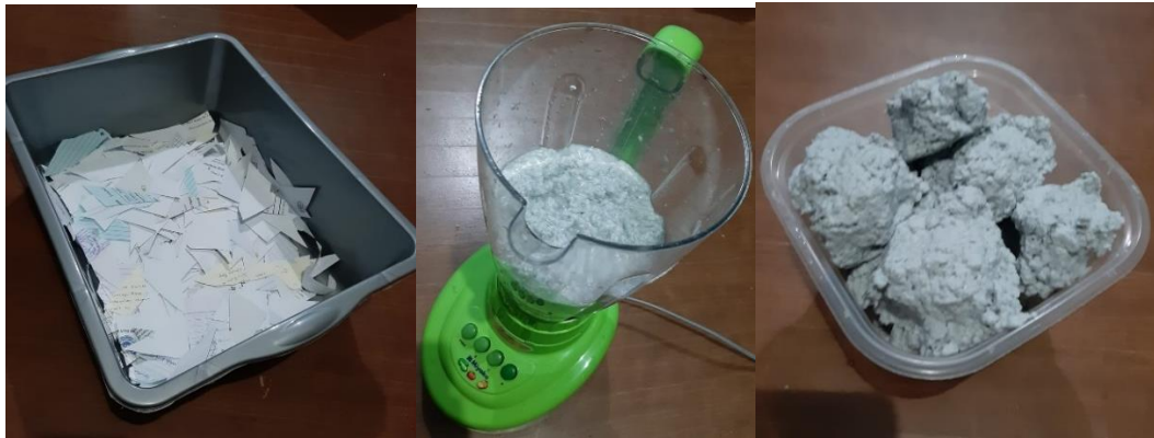
Gambar 3. Tahapan Pengolahan Bubur Kertas [Sumber: Dokumentasi Peneliti]
