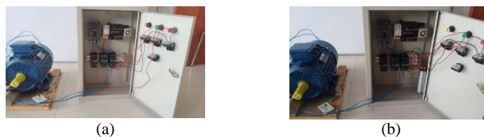
Gambar 6. (a) Rangkaian tanpa kapasitor bank (b) Rangkaian menggunakan kapasitor bank
