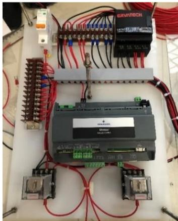
Gambar 2. Komponen pada Modul Kontrol
