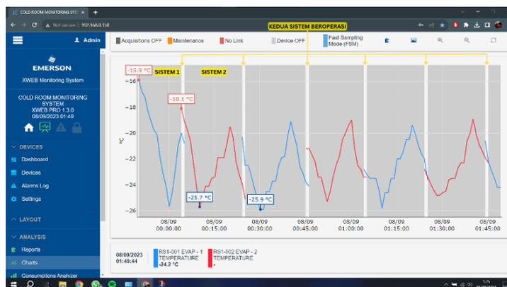
Gambar 13. Grafik Temperatur Pengujian Mode Auto selama 2 Jam
