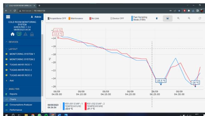
Gambar 11. Grafik Temperatur Pengujian Mode Manual Selama 30 Menit
