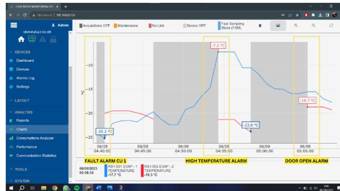
Gambar 18. Grafik Temperatur Pengujian *Alarm* selama 30 Menit
