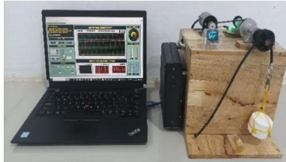
Gambar 10. Alat Media Pembelajaran Kendali PID Pada Kecepatan Motor DC Berbasis Arduino dan LabVIEW
