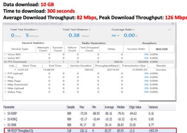
Gambar 7. Hasil Pengukuran FTP Server pada site ZMDU\_0406.
