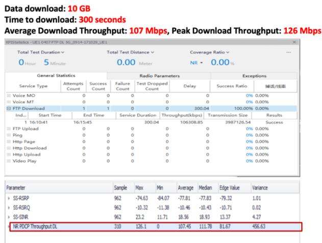
Gambar 8. Hasil Pengukuran FTP Server pada site ZMDU\_0407.
