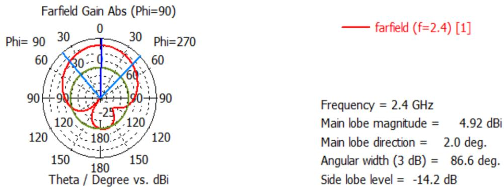
Gambar 7. Hasil Simulasi Pola Radiasi Antena
