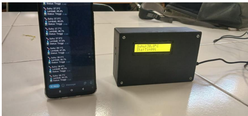
Gambar 9. Tampilan notifikasi di Bot Telegram secara real-time
