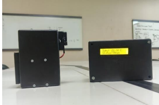
Gambar 4. Pembacaan Sensor DHT22
