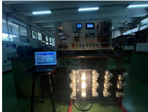
Gambar 5 Pengujian Manual pada Beban Resistif
