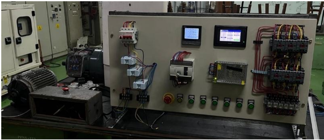
Gambar 7 Pengujian Manual pada Beban Induktif (1 Motor 3 Fasa)
