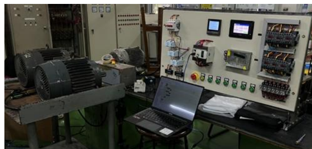
Gambar 12 Skenario Pengujian Dinamis pada Beban Induktif
