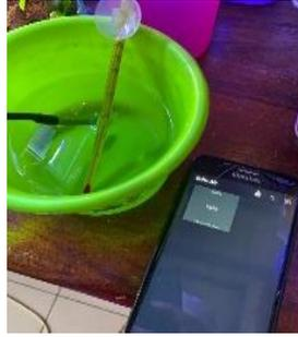
Gambar 3 Pengujian keakuratan termometer dengan sensor suhu
