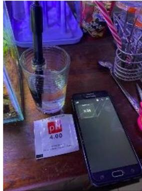
Gambar 9 kalibrasi keakuratan pH meter dengan sensor pH
