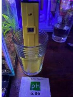
Gambar 6 Hasil kalibrasi pH meter untuk nilai pH 6.86
