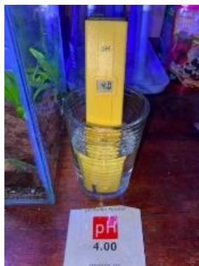
Gambar 8 Hasil kalibrasi pH meter pada nilai pH 4.00
