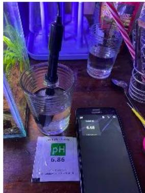
Gambar 7 kalibrasi keakuratan pH meter dengan sensor pH
