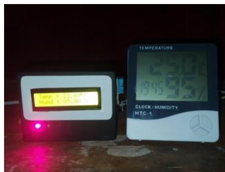
Gambar 4. Pengujian Sensor DHT 22 terhadap hygrometer HTC-1
