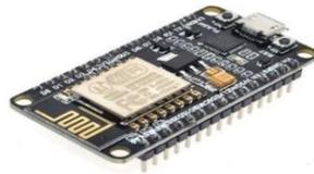
Gambar 1. *NodeMCU ESP8266*
